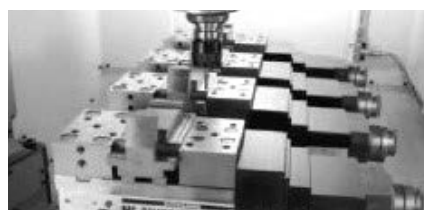
※パワーバイス参考写真… 金属を加工する際、金属を挟んで 固定するもの
